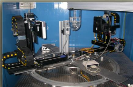
**CT and SPECT Breast scanner---BREAST-CT**, Primo prototipo europeo di Cone-Beam Breast CT/SPECT per indagini di laboratorio. **Distretto Biophysics della Regione Campania.**
